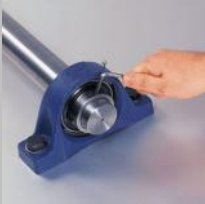
3. 將軸承中的軸在軸向上定位，如可能，轉動幾圈。將軸承內圈延伸面上的沉頭螺釘完全擰緊
