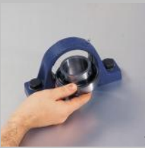
如果是鑄鐵軸承座，最好讓軸承座空孔的潤滑槽偏開軸的鎖定部位
