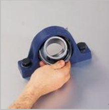
然後可用一根木桿或管子將軸承頂到其在軸承座中的位置
